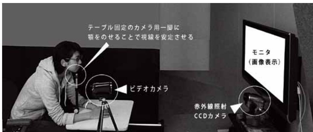
図 1 【視線測定方法】 CCD カメラを用いて、レンズ中央部から微量の近赤外光を眼球に照射し、被験者の眼球を撮影する。
